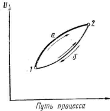
Рис. 25. К выводу математической формулировки второго начала термодинамики для необратимых процессов
